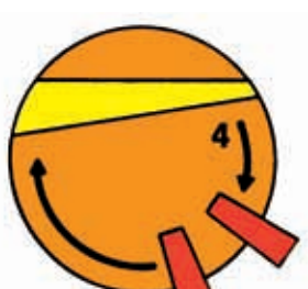
4 Tăierea completă din zona tensionată spre cea netensionată
