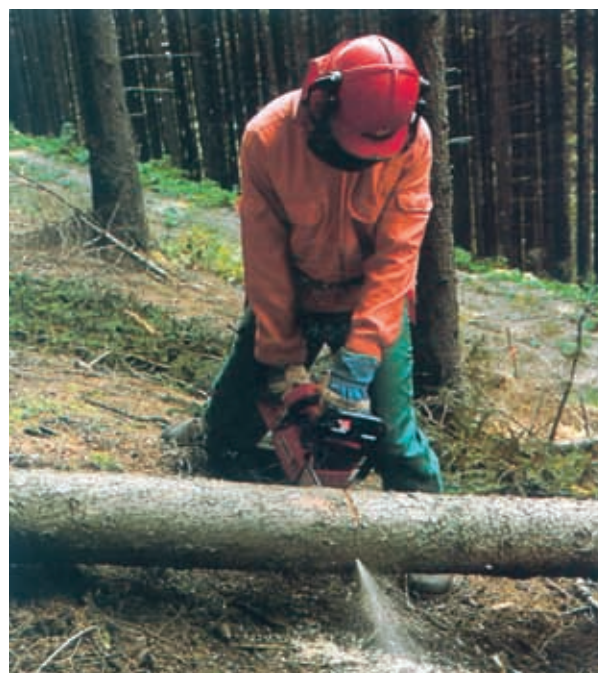
Motofierăstrăul sprijinit de corpul drujbistului, colții de prindere nu au voie să atingă lemnul
