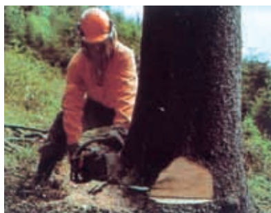
Poziția ideală și ținerea motofierăstrăului la doborât.
