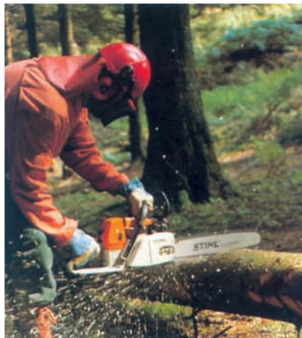
Motofierăstrăul sprijinit cu colții de prindere de buștean
