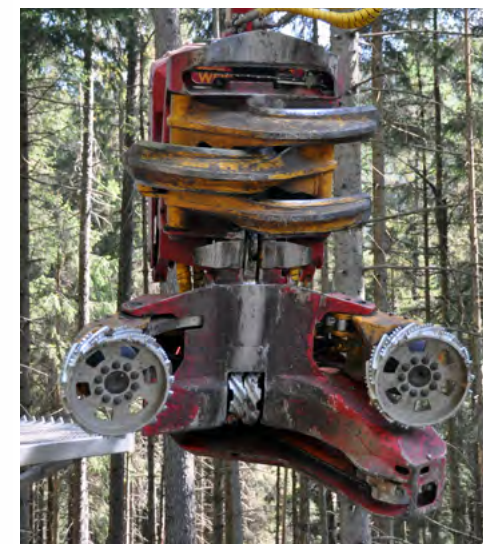
Adaptiertes Aggregat für die Entrindung im Jahr 2022
